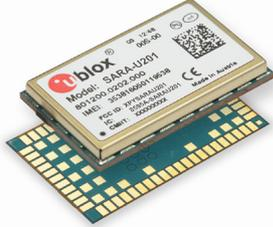
瑞士塔尔维尔（2016 年 2 月 4 日）——全球无线及定位模块和芯片领导者瑞士 u-blox（SIX:UBXN）宣布推出超紧凑 SARA-U201 3G/2G 蜂窝模块。96 针 LGA 封装 SARA-U201 尺寸仅为 16 x 26 x 3 mm，是支持 2G 和 3G 连接的最小无线模块，并带有最新 3G 芯片支持 LoT 应用。
